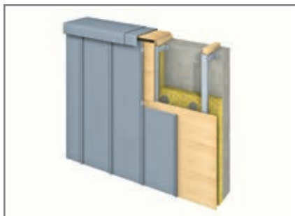
Raccord de couvertines sur acrotère
